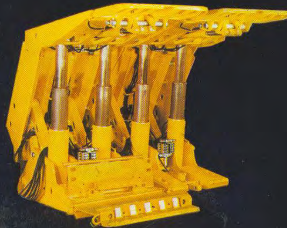
Schildausbau G 520 - eingefahren 1,20 m/ausgefahren 2,75 m
