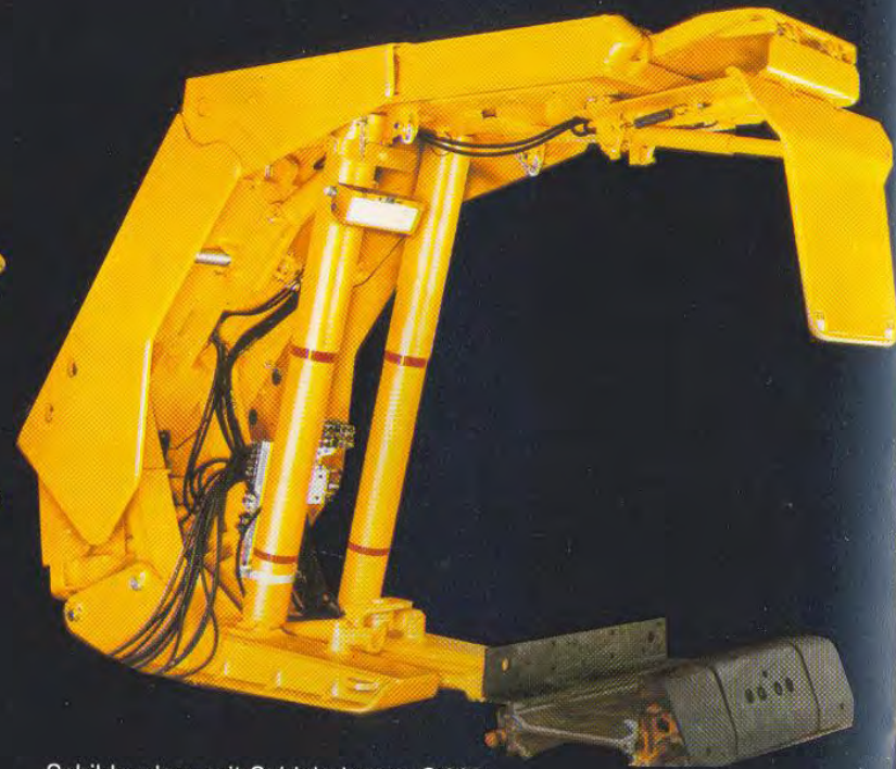
Schildausbau mit Schiebekappe G 320 - eingefahren 2,00 m/ausgefahren 3,10 m
