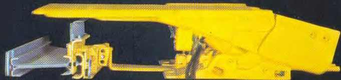
Schildausbau G 320 - eingefahren 0,50 m
